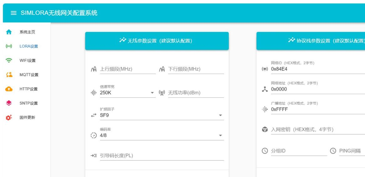
其中，无线参数设置包含 LoRa 无线通信相关的必需参数：上行/下行频段，信道带宽，无线发射功率，扩频因子，编码率和前置引导码的长度，根据实际项目需要进行配置即可，点击“设置”按钮即可保存到网关。注意以上参数配置需跟 LoRa 终端节点的参数一致（上/下行频段在终端节点上需要反置）。
