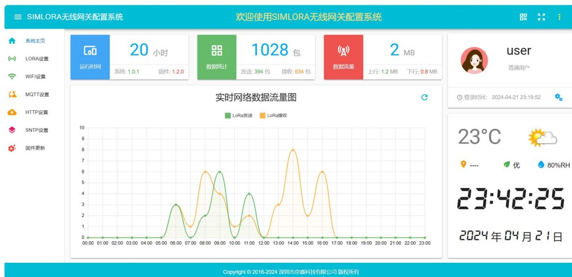
其中系统左侧为配置选项，分别对应各项参数的配置。系统首页显示网关的工作状态信息和网络数据流量等信息，首页的图表记录当天的 LoRa 网络数据流量信息，按每个小时的时间段进行记录和展示。
